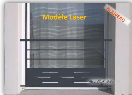
Traverses haute et basse profil creux 40 x 27 Montants verticaux en fer plat 40 x 6 mm Remplissage tube Ø20 Soubassement tôle de 2 mm découpe laser
