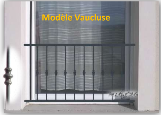
Traverses haute et basse profil creux 40 x 27 Barreaudage plein Ø 14 avec bague soudée au centre H 65 x l 40
