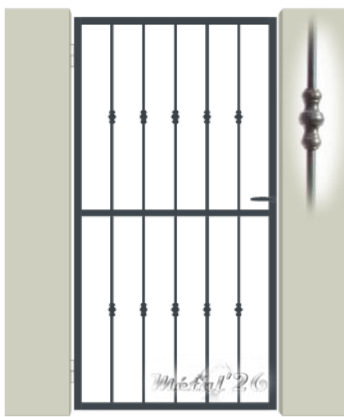
Barreaudage rond plein Ø14 Bague H 65 x l 40
