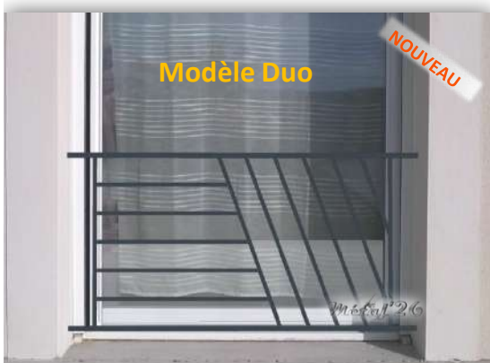
Traverses haute et basse profil creux 40 x 27 Montants verticaux en fer plat 40 x 6 mm Barreaudage profil creux □ 20 Soubassement plexiglass makrolon épaisseur 8 mm maintenu par pinces à plexiglass
