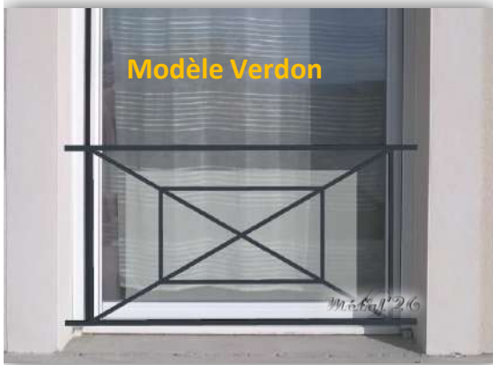
Traverses haute et basse profil creux 40 x 27 Montants verticaux, barreaux et motif profil creux □ 20 Remplissage plexiglass makrolon épaisseur 8 mm maintenu par vissage
